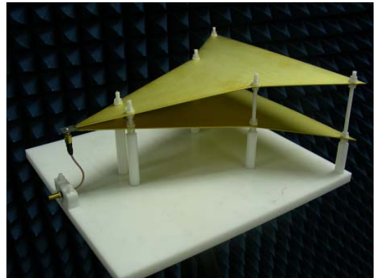
그림 6. 제작된 TEM 혼 안테나 사진 Fig. 6. Photograph of the fabricated TEM horn antenna.
